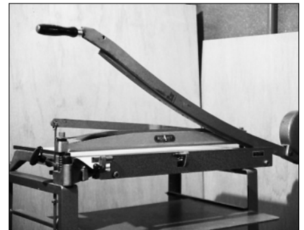
Abb. 6: Schwenkmesser mit Gegengewicht
