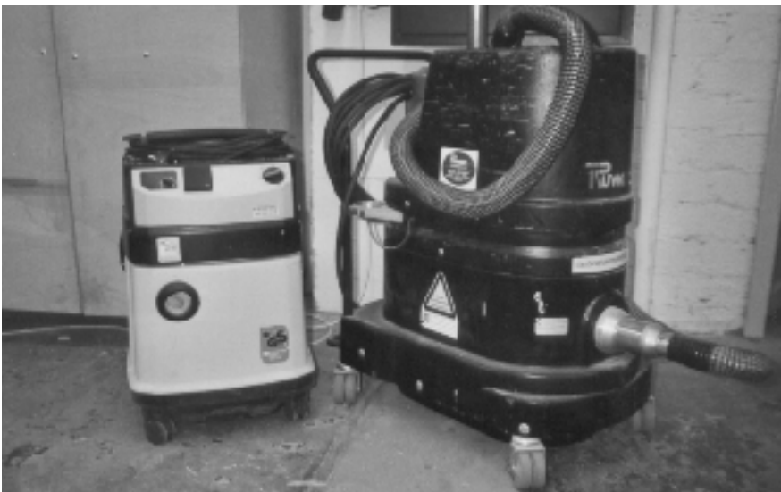
Bild 1: Geeignete Industriestaubsauger zum Ab- und Aufsaugen von Holzstaub (Foto: Ludger Hohenberger)
